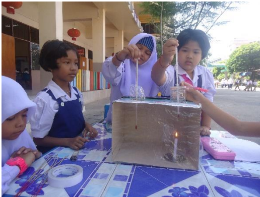
ภาพที่ 7 วัดอุณหภูมิในกล่องทั้งสอง ในขณะที่จุดเทียน 1 กล่อง ภาพ : พิมพ์พิชชา คำไข
