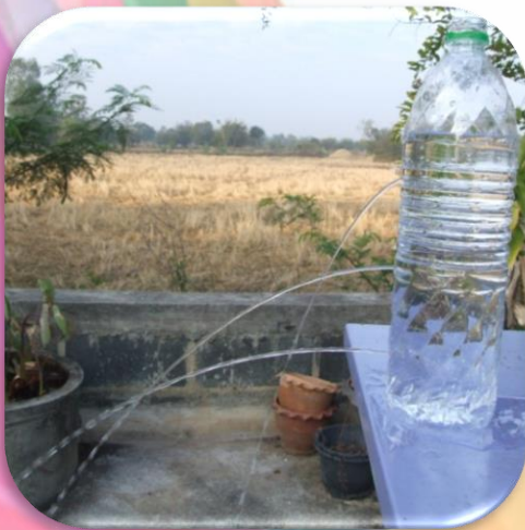
ภาพที่ 9 น้ำที่ระดับลึกจะมีแรงดันมากกว่าน้ำที่อยู่ระดับตื้น
